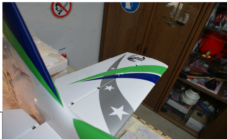
Das Höhenleitwerk im angeschraubten Zustand.
